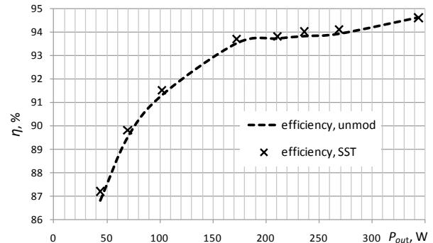
Fig. 6. Efficiency  $\eta$  vs.  $P_{out}$  ( $f_{sw}=100\text{kHz}$ ;  $\Delta f_{sw}=30\text{kHz}$ ;  $f_m=2.5\text{kHz}$ )
