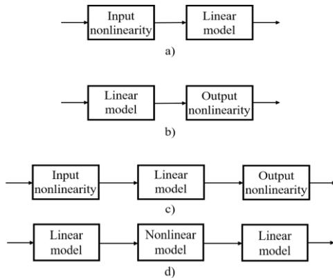
Fig. 1. (a) Hammerstein model structure; (b) Wiener model; (c) Hammerstein-Wiener model; (d) Wiener-Hammerstein model.
